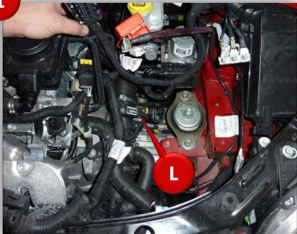
Den Ladedrucksensor Stecker lösen.
