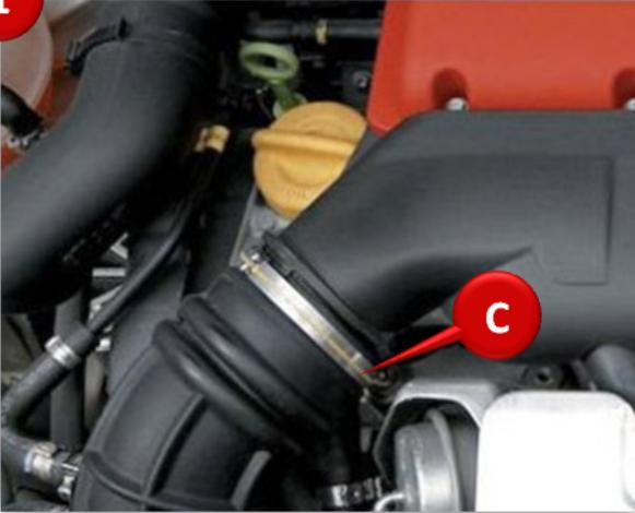
Für die Demontage der Motorschutzabdeckung müssen gegebenenfalls Clic ® Schellen (C) gelöst werden.
