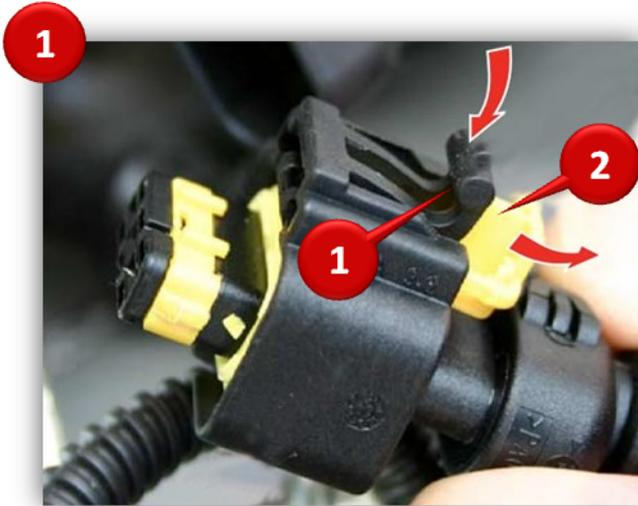
Die Lade- und Saugrohrdrucksensor-Stecker sind doppelt gegen Abrutschen gesichert. Um den Stecker abziehen zu können, muss zunächst der gelbe Riegel (2) am Stecker herausgezogen werden. Der Riegel ist mit dem Stecker fest verbunden und kann nicht abfallen.
