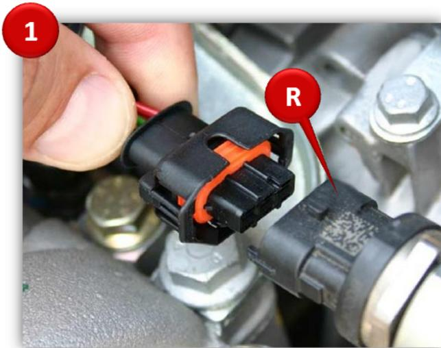
Der Stecker des neuen Kabelbaums wird jetzt am Raildrucksensor (R) befestigt.
