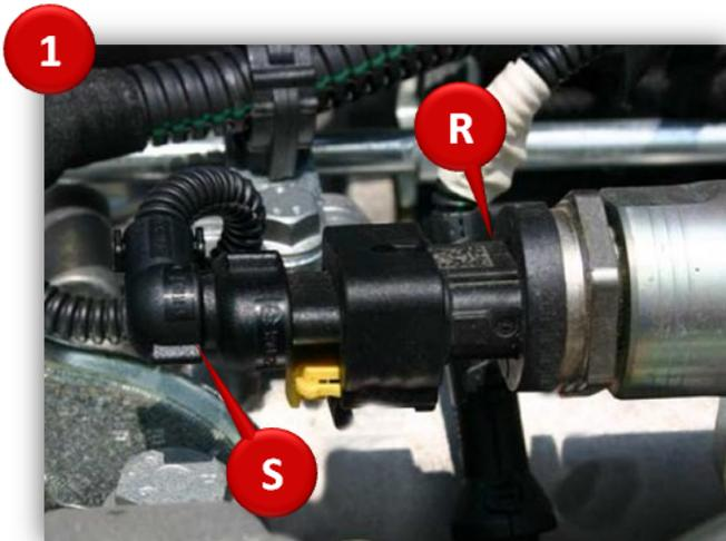
Den Raildrucksensor Stecker (S) vom Raildrucksensor (R) lösen.
