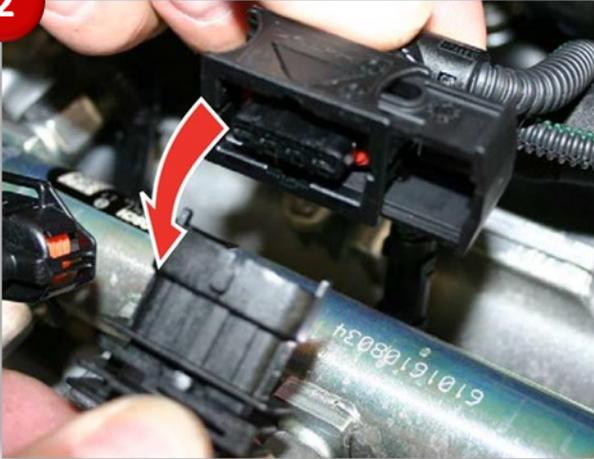
Den Stecker vom Ladedrucksensor abziehen und mit dem entsprechenden Stecker des Kabelbaums verbinden.
